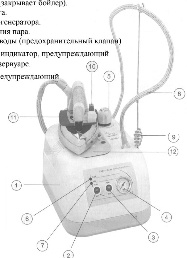
8. Двойное соединение, состоящее из кабеля, соединяющего корпус парогенератора и утюг, и шланга парогенератора
